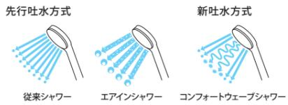
コンフォートウェーブシャワーは、ウェーブ吐水と従来シャワーの吐水を組み合わせることでエアインシャワーと同等の約35%の節水を実現。
