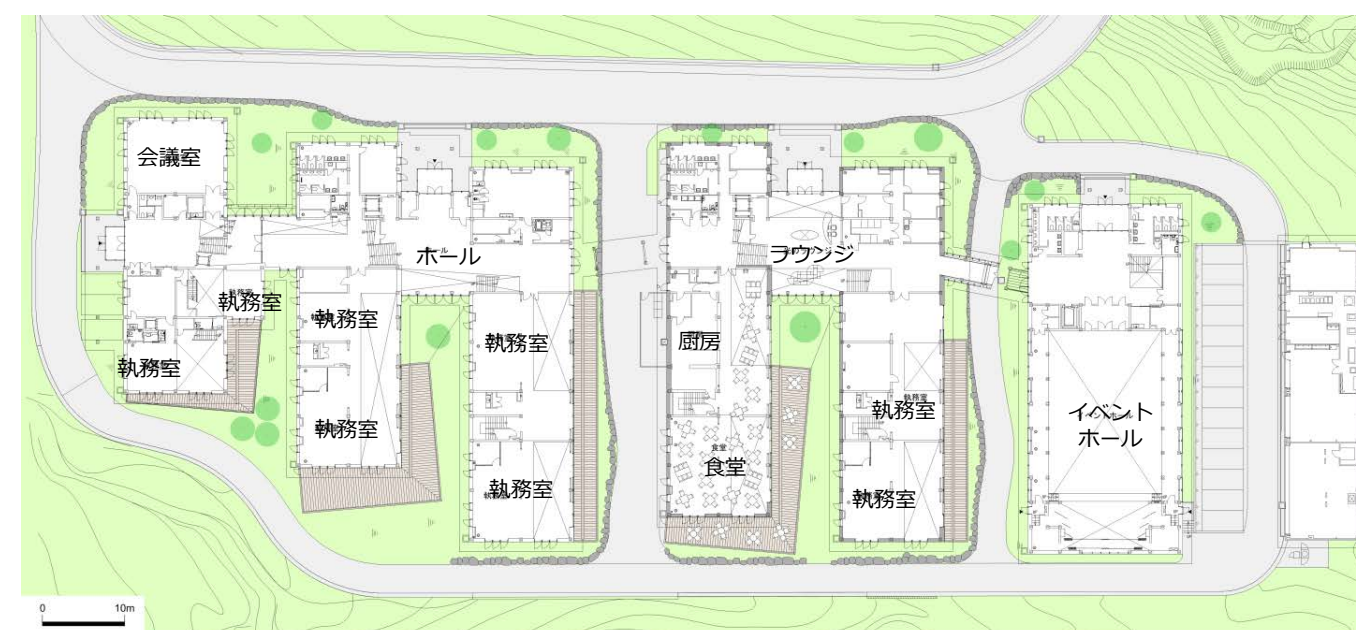
配置図 (隣棟間隔を確保した分棟配置)
