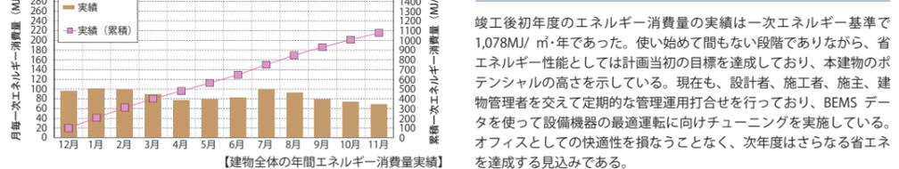
竣工後初年度のエネルギー消費量の実績は一次エネルギー基準で1,078MJ/㎡年であった。使い始めて間もない段階でありながら、省エネルギー性能としては計画当初の目標を達成しており、本建物のポテンシャルの高さを示している。現在も、設計者、施工者、施主、建物管理者を交えて定期的な管理運用打合せを行っており、BEMSデータを使って設備機器の最適運転に向けチューニングを実施している。オフィスとしての快適性を損なうことなく、次年度はさらなる省エネを達成する見込みである。
