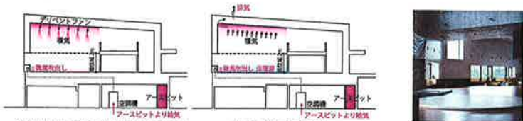
直換換気用吹き出し口がベンチとしても利用されている。
