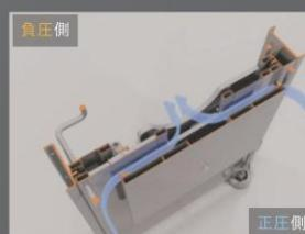
部屋間の圧力差により、主扉は閉方向の力、副扉は開方向の力を受けれる。
