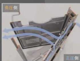
④ 主扉が受けける閉方向の力と副扉が受けける開方向の力がリンクギヤでバランスし、容易な開閉が可能となる。
